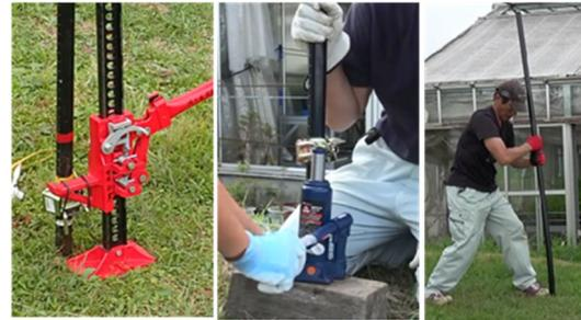
図-3. 支柱引き抜き工程試験（左：ファームジャッキ，中：油圧ボトルジャッキ，右：人力）
