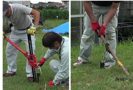
図-4. アンカー引き抜き工程試験（左：ファームジャッキ，右：引き抜き棒）
