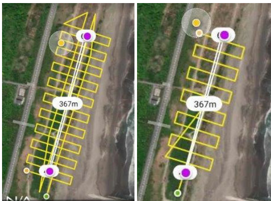
図-2. GSRTK アプリで作成した白子1区の撮影高度 70 m (左) と 100 m (右) の飛行コース
