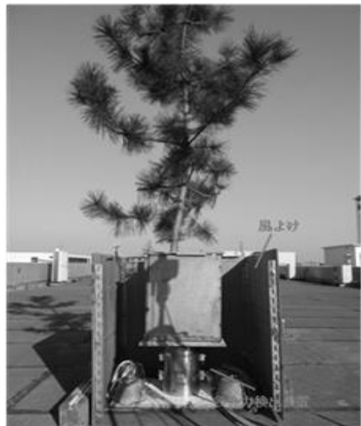
図-1. 自然風による風力計測
