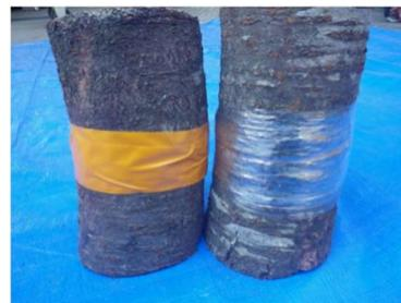
図-1. 接合資材(左：5cm幅布テープ、右：10cm幅ラップ(リケンテープ；塩化ビニル樹脂))
