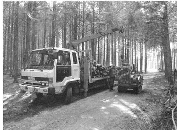
図-2. トラッククレーンを利用した積込
