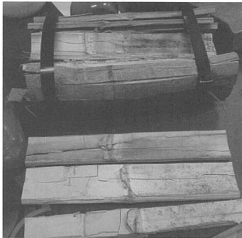
図-6. 部分圧縮試験後の試験体
