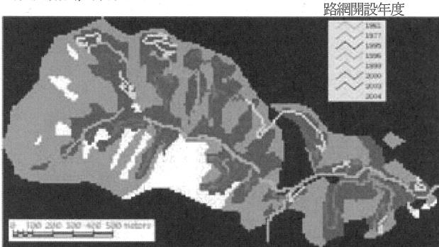
図-5. 機械移動費を導入して作成した循環路網
