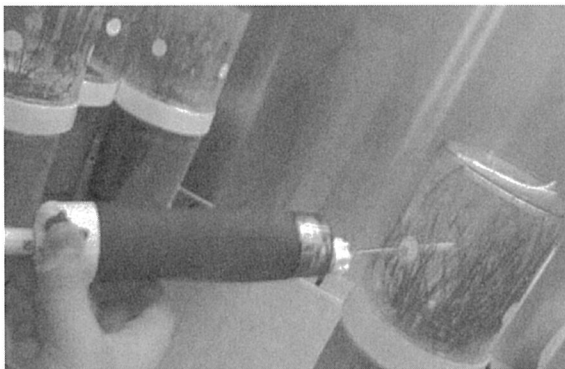
写真-1. 北川式ガス検知管による測定の様子
