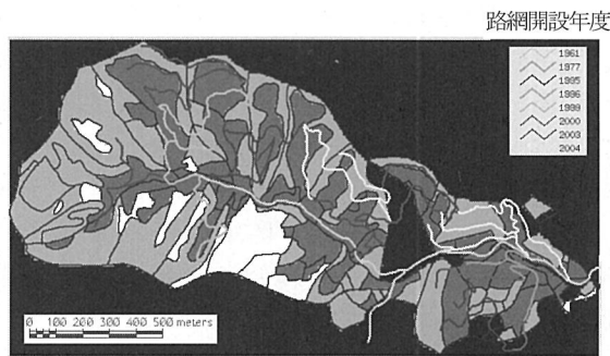
図-3. 現況路網と樹種の重ね合わせ（青：小班界，濃灰色：スギ，淡灰色：ヒノキ，白：広葉樹，黒：対象外地域）
